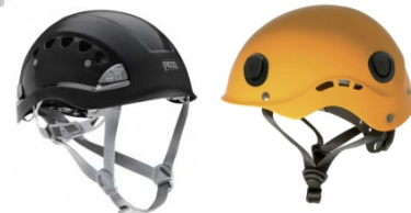
Figura 2: Ejemplos de cascos que siguen la norma EN-12492. Vertex Vent a la izquierda y Black diamond a la derecha, ambos con barboquejo resistente hasta 50 daN y ventilación.
