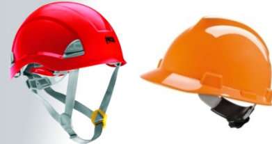
Figura 1: Ejemplos de cascos que siguen la norma EN-397. Vertex ST a la izquierda (barboquejo resistente hasta 25 daN) y V-Gard a la derecha (sin barboquejo).
